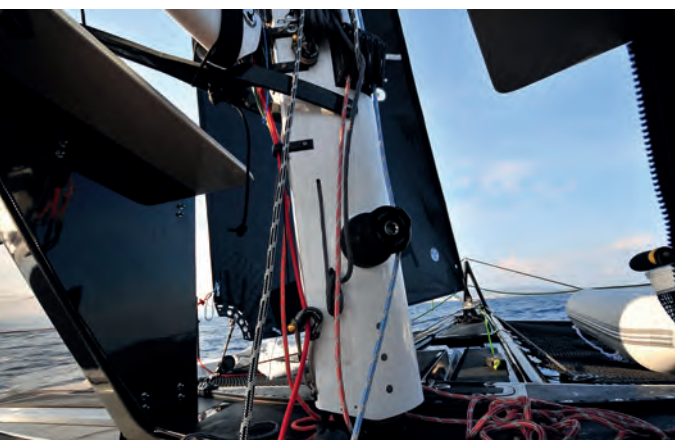
Le mât rotatif et la bôme sont réalisés en carbone de chez Pauer Ltd ; le gain en termes de poids est de l'ordre de 40 % comparé à l'aluminium.
