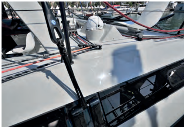
Barre de liaison des safrans, lashing du haubanage : l'IC36 a été peaufiné et optimisé jusqu'aux derniers détails.
