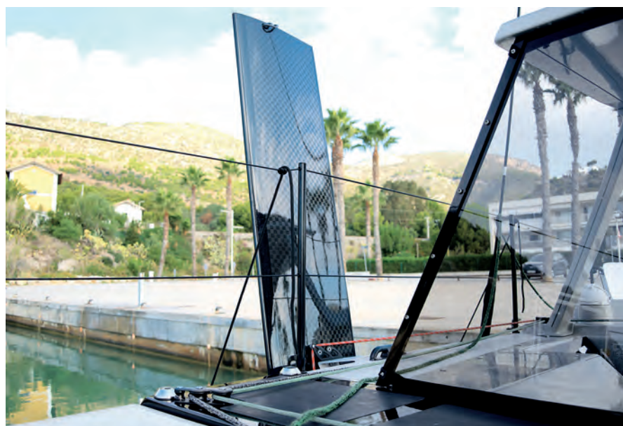
Vysouvací ploutve jsou z kevlarového kompozitu.
