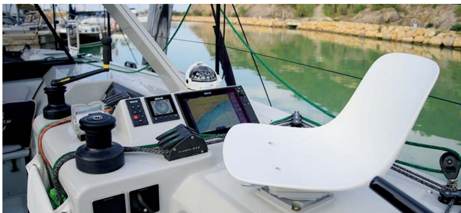
U obou kormidelních stanovišť jsou k dispozici i displeje navigačních přístrojů.
