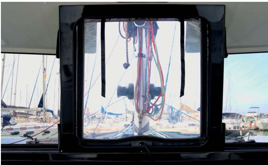
Vinšny na stěžni je možné ovládat nejen z přední paluby, ale i z kokpitu.
