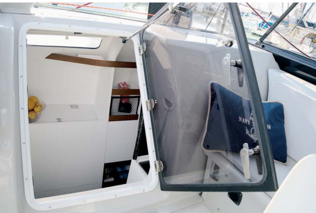
Vstup do plováků s průhlednými dveřmi a vodotěsnými uzávěry.
